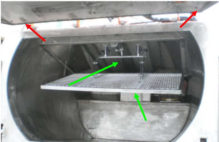
9. Schmutzwasserumlaufsystem\* reinigen:
