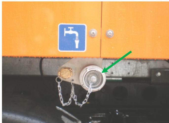
4. Wasserfilter an Hydrantenanschluss stecken und Wasserfüllschlauch zwischen Tankfüllanschluss und Wasserfilter anschließen. Hydrantenventil öffnen.
