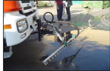
Tellerbesen vor der Stoßstange, 900 mm Ø nach rechts ca. 800 mm stufenlos über Fahrzeugaußenkante teleskopierbar, Auflagedruckverstellung u. Drehzahlverstellung pneum., über Zusatzsteuerpult vom Fahrerhaus aus t und Öse für die Demontage.
